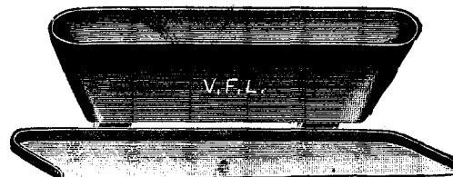
in den Trichter wirft. Durch den feinen unteren Spalt des Trichters wird die Substanz verteilt, und größere Stücke werden zurückgehalten, die man alsdann leicht zerdrücken kann. Je feiner der untere Spalt, und je geringer der Abstand von der unteren Trichteröffnung zum Schiffchen ist, desto sicherer geschieht die Füllung.
